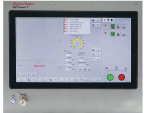
■ Edge Connect CNC'yi 19" dokunmatik ekran ile endüstriyel bir mahfazaya entegre eder
