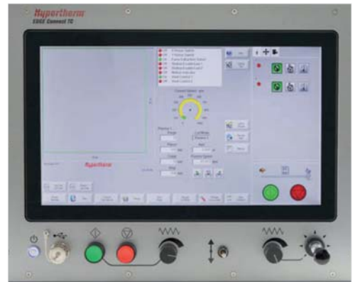
■ Edge Connect T'yi temel alır; ek olarak başlatma, durdurma, programlama ve manuel hız kontrolü, torç indirme/kaldırma ve joystick siviçleri için bir donanım operatör konsolunu içerir
