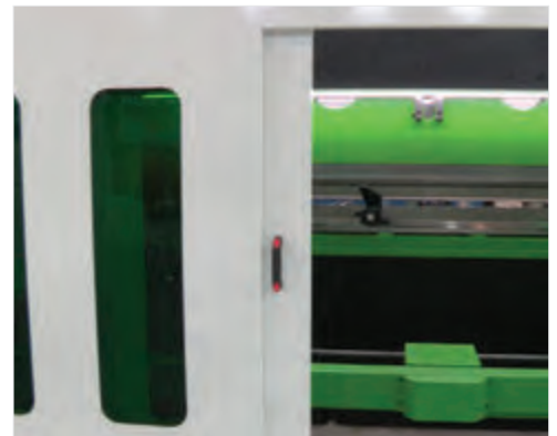
■ Arka sürgülü kafes ve siviç sayesinde güvenliğinizi maksimum seviyeye çıkarın. Pencereler sayesinde makinenin içini kontrol edin (S)
