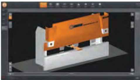
■ Makine üzerinde parçanın 3B görüntüsü gösterebilir aynı zaman da büküm sırasını da hesaplayabilir
