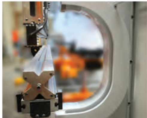
■ Geniş bükümler için 1500 mm'ye kadar özel boğaz derinliği sunulmaktadır (O)
