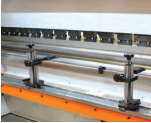
■ Power-Bend Pro standart arka dayama sistemi X eksenini motorlu, R eksenini manuel hareketli olarak sunulmaktadır (S)
