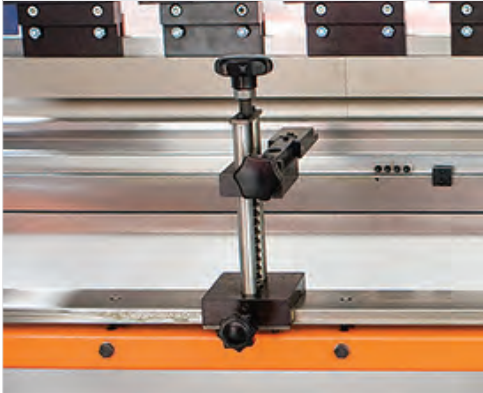
■ Özel tasarlanmış katlanabilir arka dayama dilleri (S)
